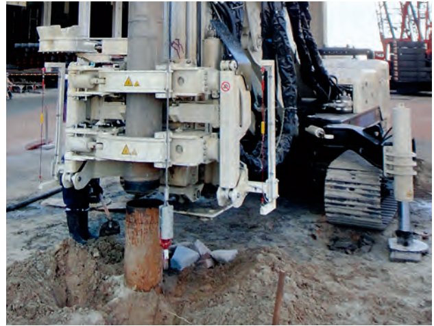
Gruppo morse con estrattore Clamp set with extraction system
